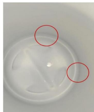
รูปที่ 4 ขวด Coffee Mate พบน้ำลงขวด (บริษัท พลาสติกและหีบห่อไทย จำกัดมหาชน)
