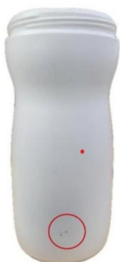
รูปที่ 3 ขวด Coffee Mate ที่เป็นจุดดำ (บริษัท พลาสติกและหีบห่อไทย จำกัดมหาชน)
