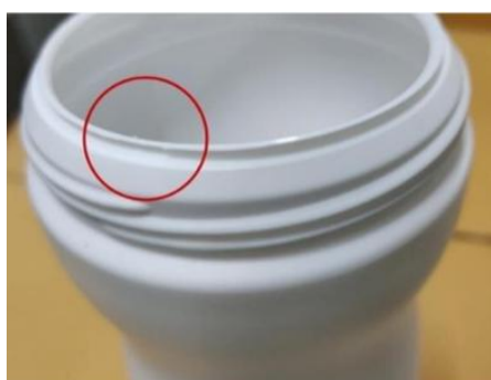
รูปที่ 5 ขวดปากขวดไม่เรียบ ปากขวดเป็นต่อ (บริษัท พลาสติกและหีบห่อไทย จำกัดมหาชน)
