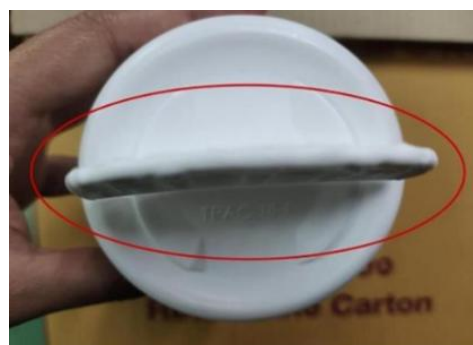
รูปที่ 6 ขวด Coffee Mate ที่มีครีบก้นขวด (บริษัท พลาสติกและหีบห่อไทย จำกัดมหาชน)
