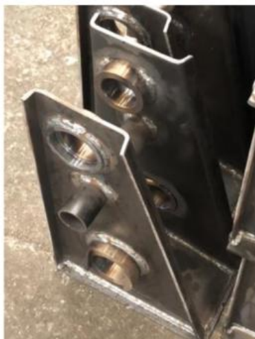
รูปที่ 4 ชิ้นส่วน (Part) หลังจากทำการ Full Weld
