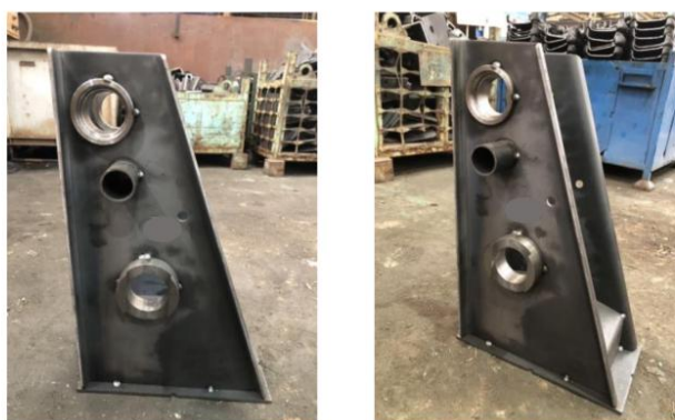
รูปที่ 2 ชิ้นส่วน (Part) หลังจากทำการ Tack Weld
