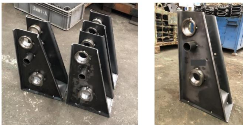
รูปที่ 9 Part Center Hanger 450 และ Center Hanger 515 ที่ Tack weld เสร็จเรียบร้อยแล้ว
