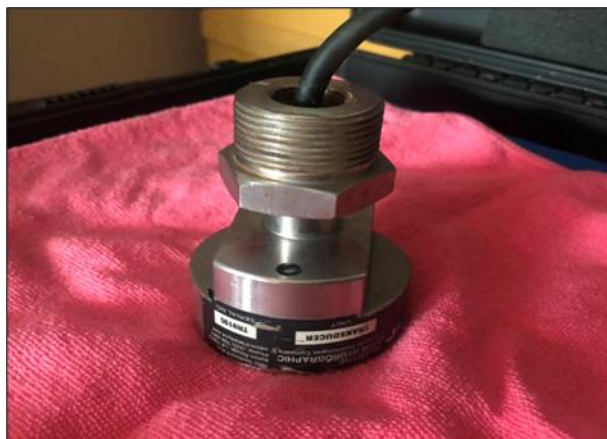
รูปที่ 3 ตัว TRANSDUCER รับ-ส่งสัญญาณคลื่นความถี่
