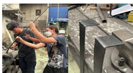
การตัดเหล็กเพื่อทำแปลนยึดน็อต
