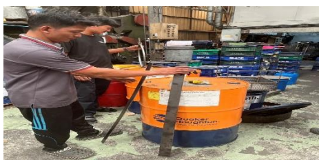
การวัดขนาดเส้นรอบวงถังน้ำมัน
