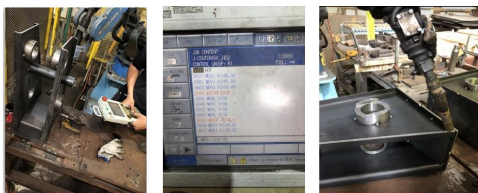
รูปที่ 10 การ Teach โปรแกรมหุ่นยนต์ตามร่องขอบให้ครบบนชิ้นงาน (Part)
