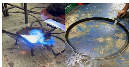
รูปที่ 2 แสดงขั้นตอนการพัฒนาอุปกรณ์ยึดจับเพื่อเคลื่อนย้ายถังน้ำมันขนาด 200 ลิตร โดยรวม
