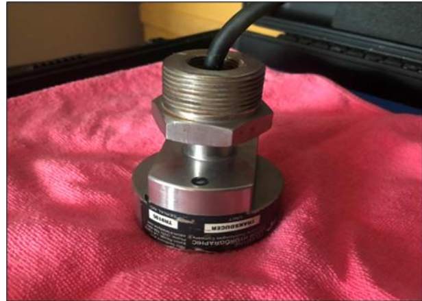
รูปที่ 3 ตัว TRANSDUCER รับ-ส่งสัญญาณคลื่นความถี่
