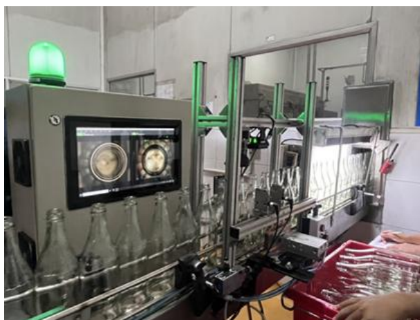
รูปที่ 10 ตรวจสอบโดยเครื่องตรวจสอบปากขวด
